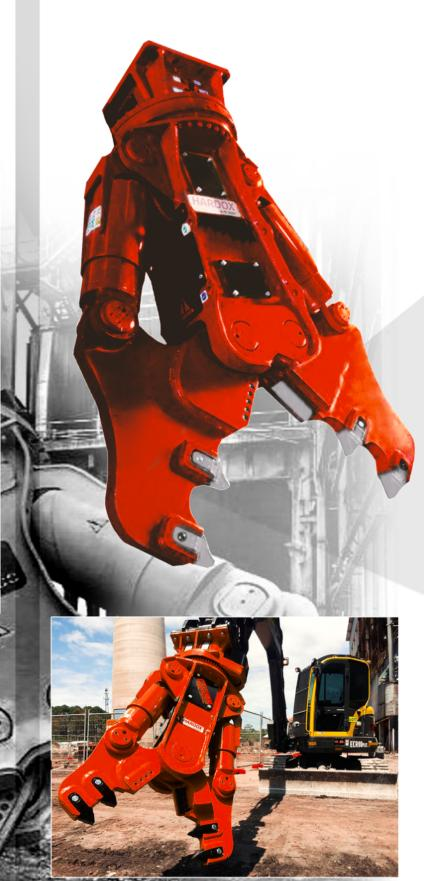
La serie **EPC FRANTUMATORI PRIMARI** è studiata per poter svolgere lavori di demolizione primaria e secondaria. Costruiti in HARDOX 400, naturalmente resistenti all'usura, la serie EPC, totalmente girevole, possiede un circuito di rigenerazione che permette di ottenere veloci cicli di apertura e chiusura a vuoto della mascella.
